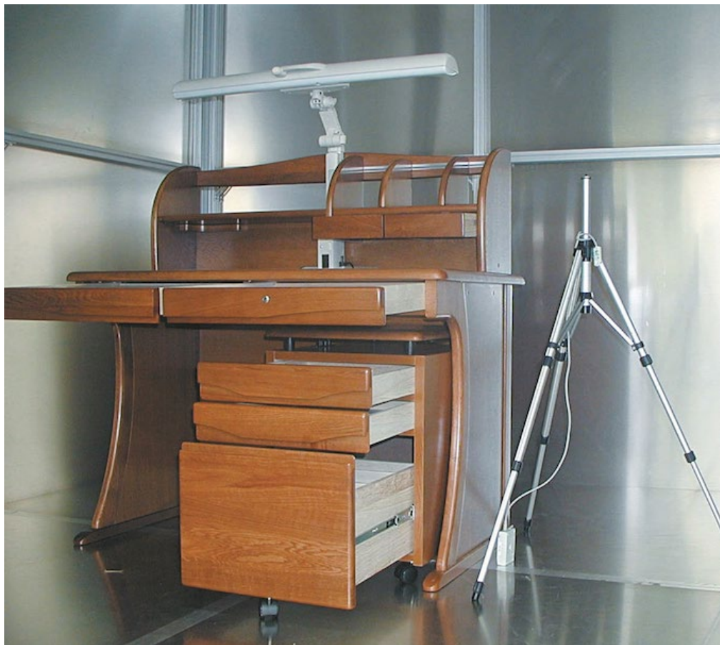
図表 15: 実験室でのダイオキシシン放散値測定
