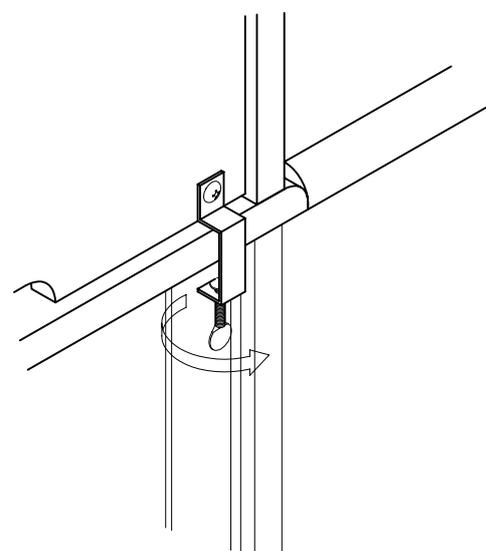
※ジョイント金具のネジを締めます。
