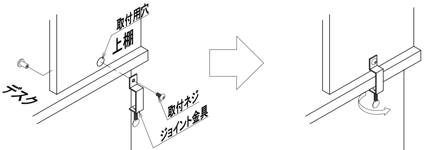
※ジョイント金具のネジを締めます。
