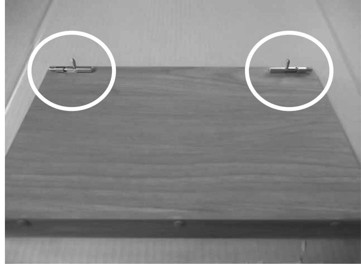
本体側板にある金ダボ取り付け用のネジ穴に棚板裏の左右にあるスライドラッチのシャフトをあわせ、レバーを外してネジ穴に差し込みます。
