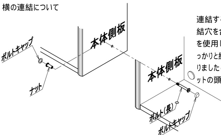
連結する2台の本体側板に開いている連結穴を合わせて、連結用ボルト(長)とナットを使用して、プラス(+ )ドライバーを用いてしっかりと締め付けてください。締め付けが終わりましたら、付属のボルトキャップをボルトとナットの頭にはめ込んでください。
