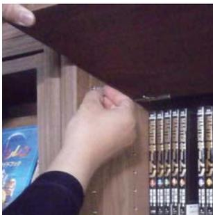
②棚が水平になる高さのメンダボへ、フラップストッパーを取り付けてください。
