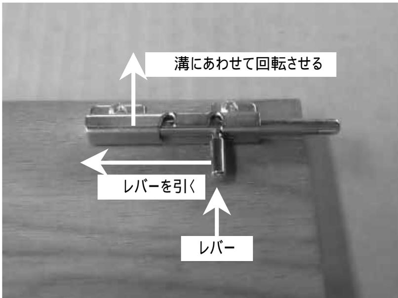
スライドラッチのレバーを金具の溝に沿って棚板の内側に引いてください。最後まで引いたら溝にあわせてレバーを上げてください。レバーを上げる事でシャフトが回転し、スライドラッチ本体にレバーがかかり、シャフトを収納した状態が継続されます。レバーを外すことでシャフトが開放されます。
