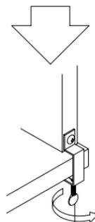
※ジョイント金具のネジを締めます。
