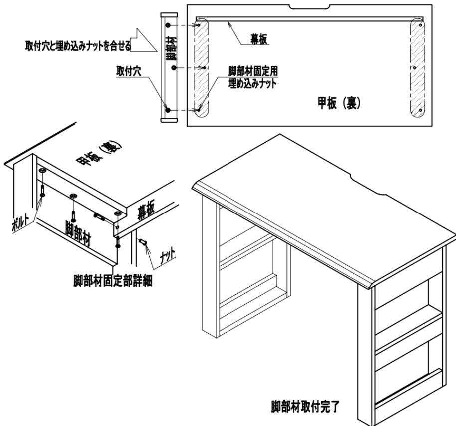
脚部材と背板の連結穴を合わせ、連結用ボルト・ナットにて固定してください。
