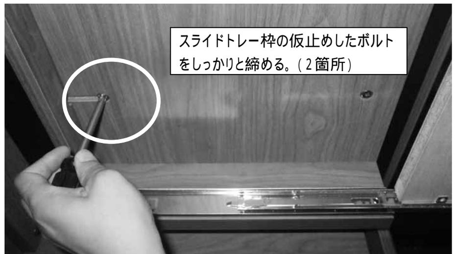
締め付けが終わりましたら、スライドトレイ枠を で仮止めしたボルトをしっかりと締めて、スライドトレイ枠をしっかりと固定してください。
