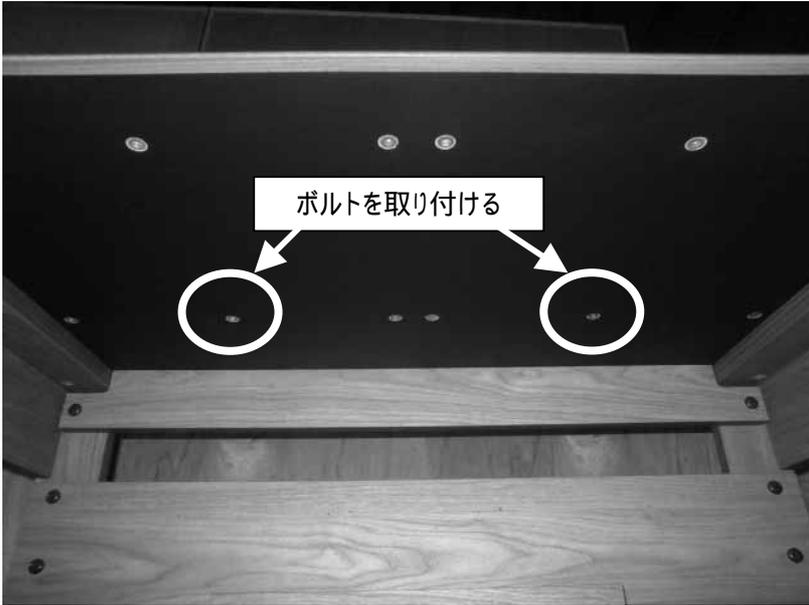
左画像の奥2箇所付属の取付ボルトを天板とネジの頭の間が21 mm程度になるくらいまで取付ボルトを締めこんで、仮止めしてください。
