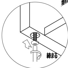
デスク天板の裏側に埋め込まれているナットに引出し枠に開いている固定用の穴をお好みの位置に合わせ、付属のボルトをプラス(+ )ドライバーを使用して固定してください。
