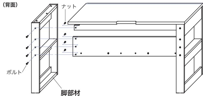
②デスク脚部材とデスク甲板を固定しているボルト（3ヶ所）を緩め取り外してください。
