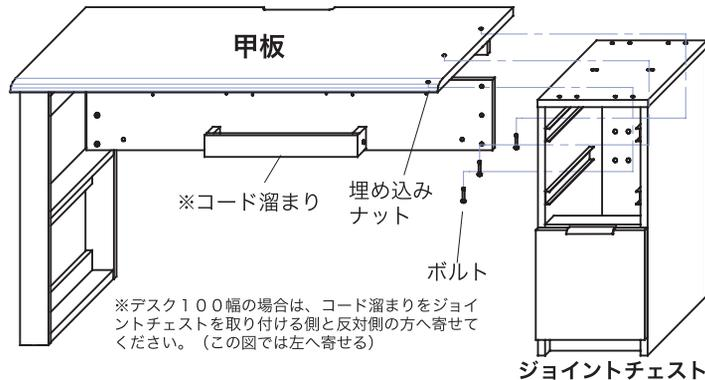
※デスク100幅の場合は、コード溜まりをジョイントチェストを取り付ける側と反対側の方へ寄せてください。(この図では左へ寄せる)
