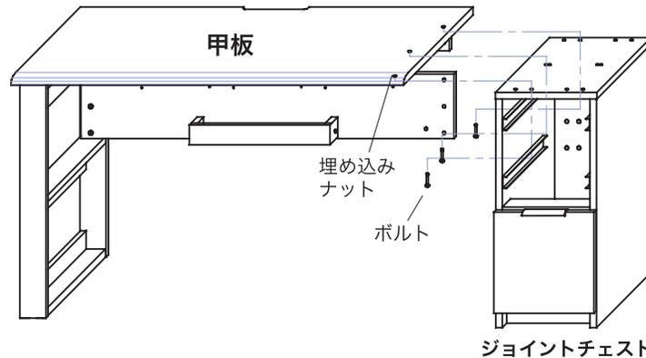
③デスク背板と幕板の後方からジョイントチェスト背面の埋め込みナットへボルト4本を使用して固定してください。
