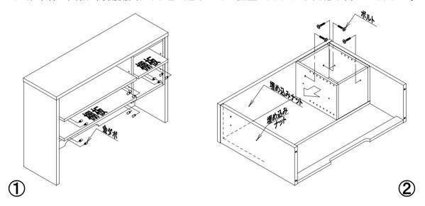
移動を終えましたら、 で取り外したボルトを使用してボックス部を固定します。ボルトで固定する際には、4ヶ所全てを仮止めしてください。
